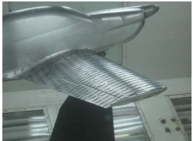
Сл. 7 Визуелизација струјања, \alpha = 17^\circ
