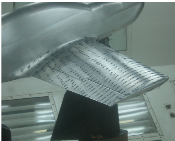
Сл. 9 Визуелизација струјања, \alpha = 24^\circ
