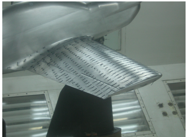
Сл. 8 Визуелизација струјања, \alpha = 21^\circ
